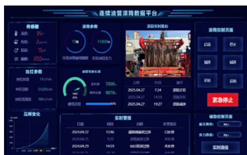
图3.6 基于数字孪生的连续油管滚筒数据可视化界面
